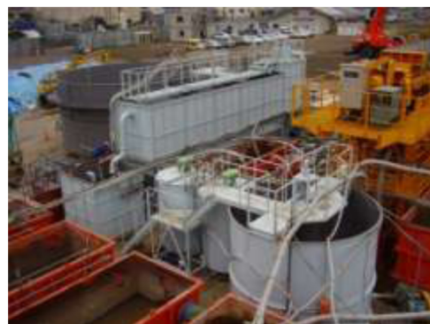
■ 実績例：土壌浄化に伴う水処理 複合汚染 80m 3 /時 関東圏内
