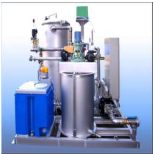
■ 実績例：池水浄化装置 10m 3 /時 堺市
